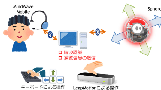
図 5 脳波と LeapMotion による Sphero 制御システムの概要図
