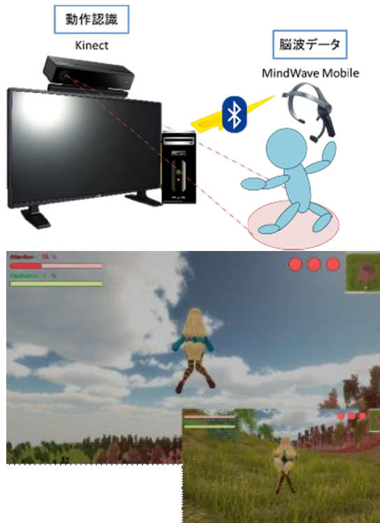
図 2 Kinect V2™ を用いた脳波システム概要図(上)と実行画面例(下)
