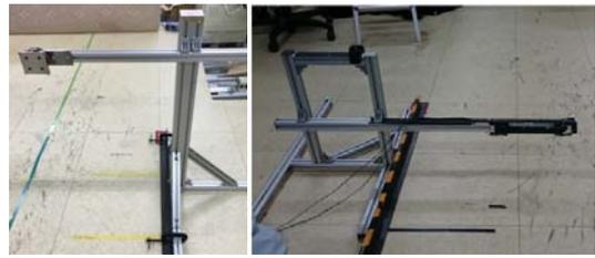
図 2. 実験用障害物(左:側面衝突, 右:つまずき)
