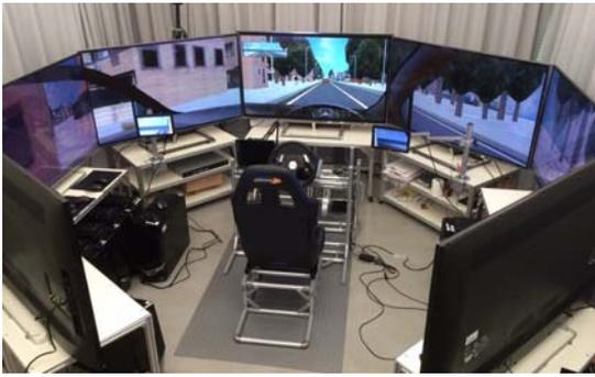
図2 ドライビングシミュレータ
