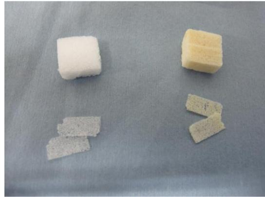
図1：PDMSのスポンジ(上)とスポンジの切片(下)。右は20wt%CaO<sub>2</sub>を含むスポンジで薄い茶色になっている
