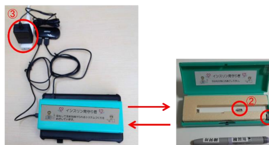
図 2 センサー付き注射器格納容器 (患者側端末)
