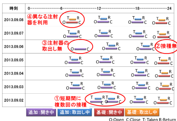
図 4 注射器利用状況の異常検知例
