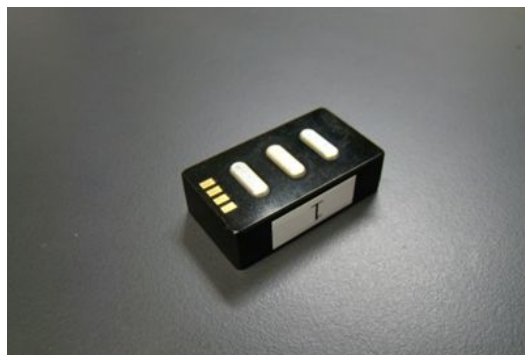
図 4 追坂電子機器製ワイヤレス筋電センサ
