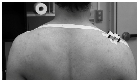
図 5 被験者の肩部に取り付けられた筋電センサ
