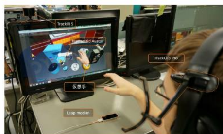
図 1. VK システムのシステム構成
