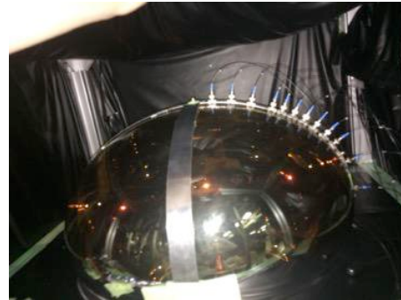
図1: PMT 応答の光入射位置依存性測定装置の一部。写真中央にあるのが 50cm 径 PMT で、その光電面に複数の光ファイバを取り付け光電面上の異なる位置に光を入射して測定を行なった。本装置全体は地磁気補償コイル中に設置している。
