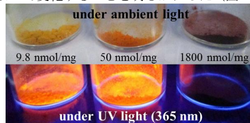
図 1. 室内光 (上) および紫外光照射 (下) における [\text{Ru}(\text{bpy})_3]^{2+} を担持したイオン交換樹脂試料の写真。
