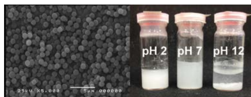
図6. ポリリシンで表面を修飾したポリスチレン微粒子の走査型多電子顕微鏡写真(左)とpH応答分散(右)
