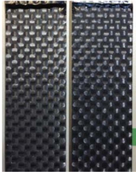
図 4 界面破壊（接着層：多層 CNT 分散エポキシ樹脂）
