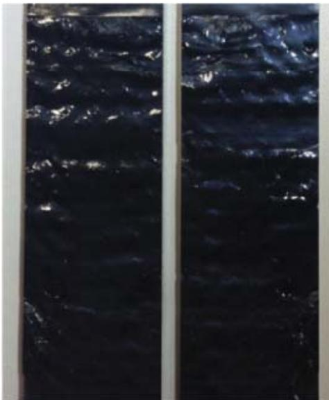
図 3 凝集破壊（接着層：多層 CNT 分散エポキシ樹脂）
