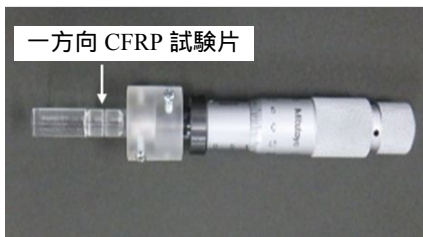
図 3 一方向 CFRP 小型試験片のための専用圧縮治具
