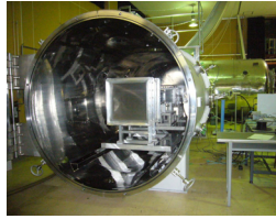
図 3:火星大気風洞
