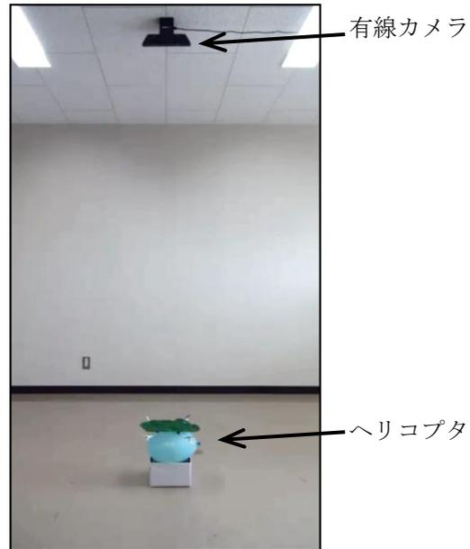
図4：カメラ天井取付型の実験装置。ヘリコプタ上部に、マーカを取り付けている。
