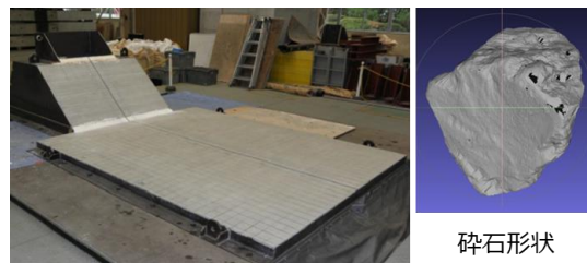
図2 模型実験 (碎石を用いた実験)
