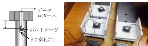
図2 ボルト軸力の計測方法
