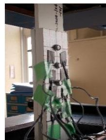
図4 小径ボルトによる接合例
