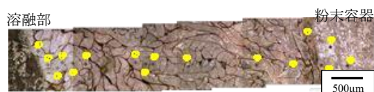
(a) 断面写真 (b) 中心軸上の拡大写真 (c) 粉末容器近傍の成形体拡大写真 図 3 切削屑のみでの固化成形体断面写真
