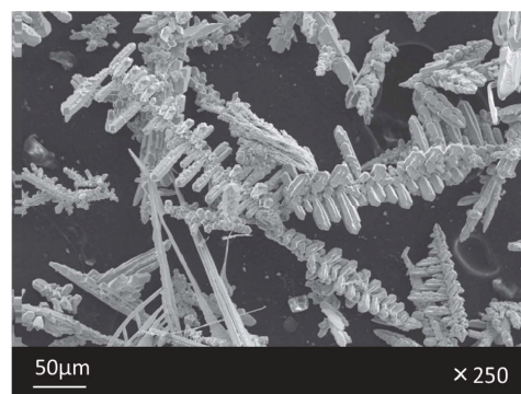
図6 定電流電解後に Ni カソードから剥離 した析出物の SEM 像。電流密度：10 mA·cm -2 。 浴組成：FLiK-10 mol% K 2 MoO 4 。
