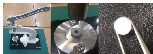
図 1 ハンドプレスおよび成型試料例
