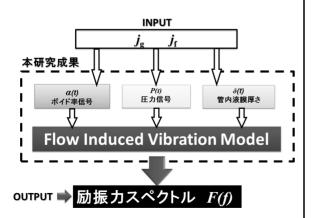
図1 励振力予測ツール概要 実験にて取得したデータベースを用い、 二流体モデルをベースとした励振力 (Flow Induced Vibration)予測モデル式 から配管曲がり部における励振力予測ツ ールを配管 25A の体系にて構築した。
