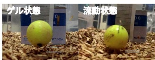
Fig. 7 可逆ゲルを導入したウッドチップ舗装路面におけるゴルフボール反発の写真（落下高さ 1 m）
