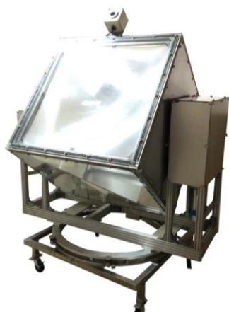
図 2. 1 m<sup>2</sup>級のフレネルレンズを搭載した、太陽励起レーザーシステム（外観）
