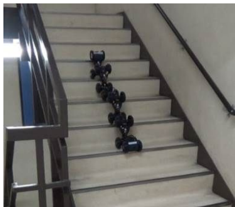
図5 多連結ロボットの階段登り
