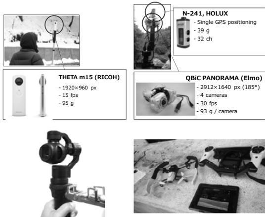
図 11. 位置情報取得可能なカメラ (左上: 二眼全方向カメラ (位置情報はタブレット端末で取得), 右上: 四眼全方向カメラ (位置情報は GPS ロガーで取得), 左下: ジンバルカメラ (位置情報はタブレット端末で取得), 右下: マイクロドローン搭載カメラ (位置情報はドローン搭載の GPS 受信機で取得))
