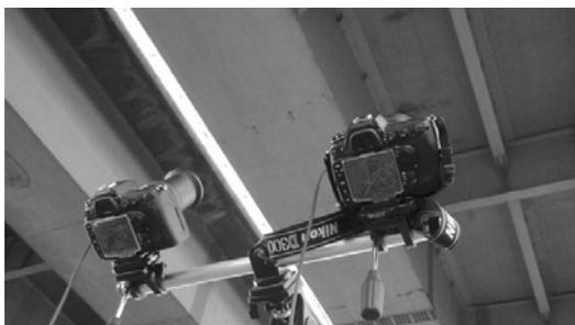
図2. 3D計測システムを用いた橋梁点検
