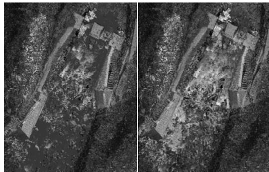
図 16. 点群データからのベースマップ (オルソ画像) 生成 (図左: 従来型手法による結果. 塗りつぶし領域が欠測領域を示す, 図右: 提案手法による結果. 欠測領域を推定し, 情報を不自然なく再構築できている)
