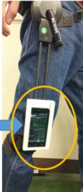
図.下肢歩行支援装具“AcSive”に機能評価を付加するため、その装具自体に装着できるようなケースをデザインし(丸印)、なかに加速度センサ(矢印)を挿入できるようにした。
