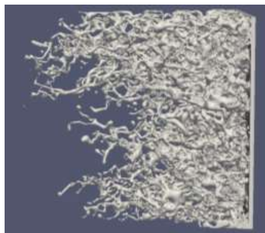
図3. Drainage 過程のシミュレーション結果 (グリッドサイズ: 1000^3 ). 白い部分が空隙内に圧入した \text{CO}_2 (Non-wettable phase) である。右側から左側に向かって \text{CO}_2 を圧入している。
