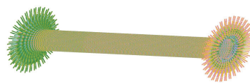
図3 ナノチューブに超伝導相関が誘起されるとナノチューブ両端にマヨラナ準粒子状態が現れる
